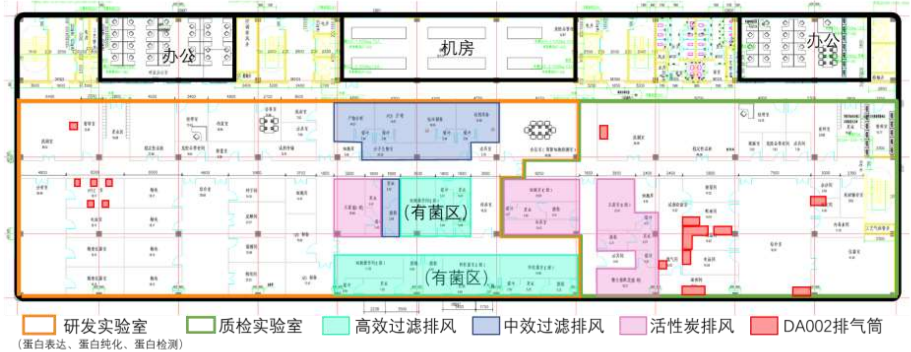
图 3-7 A 座生产楼 3 层平面布置图
