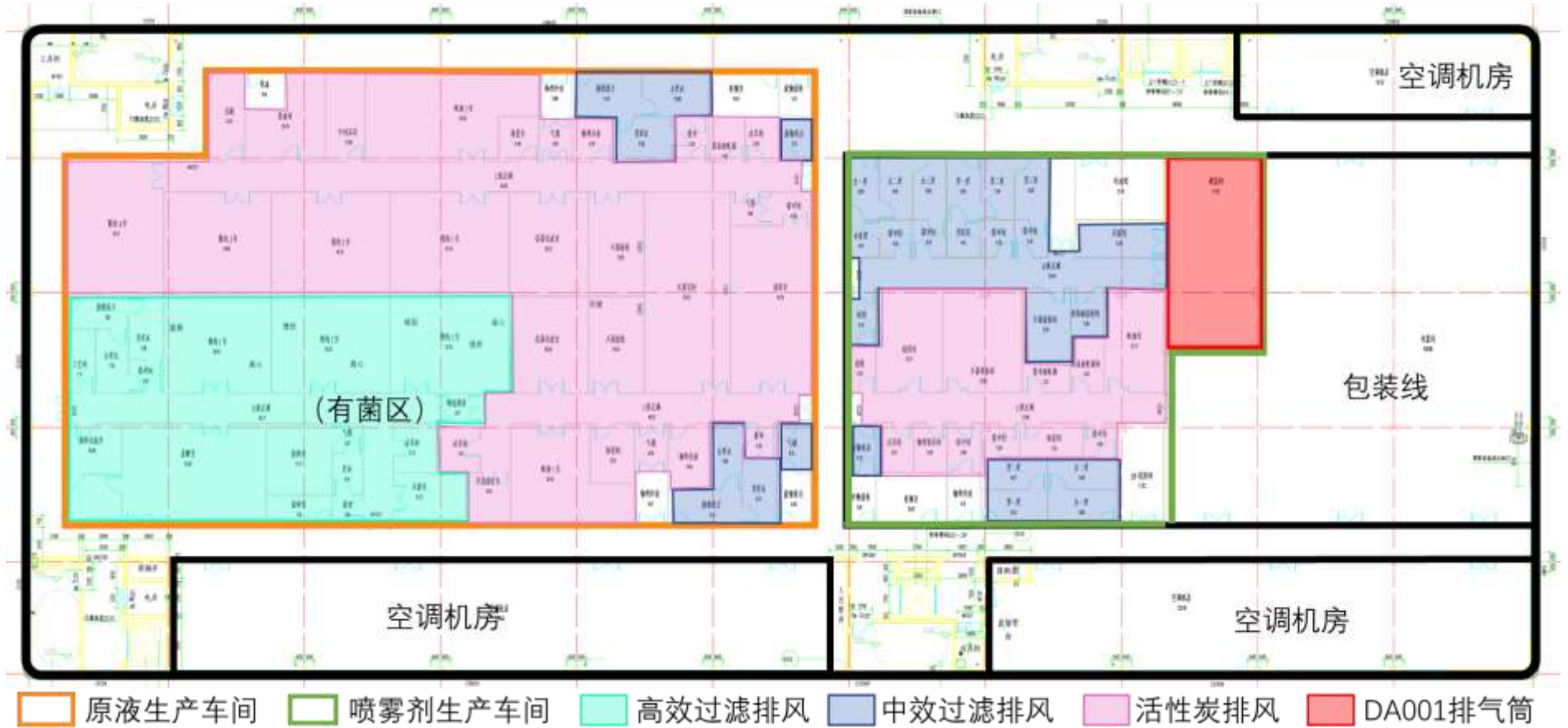
图 3-5 B 座生产楼 4 层平面布置图
