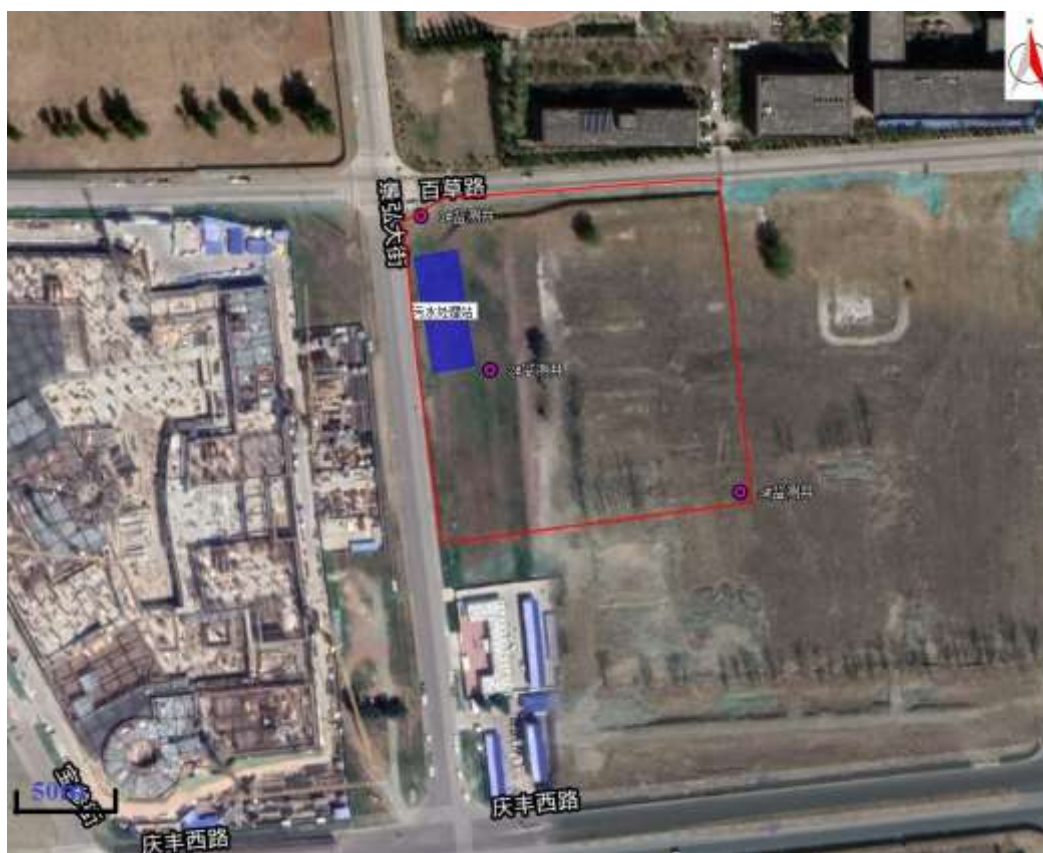
图6-4 地下水监测井布置示意图
